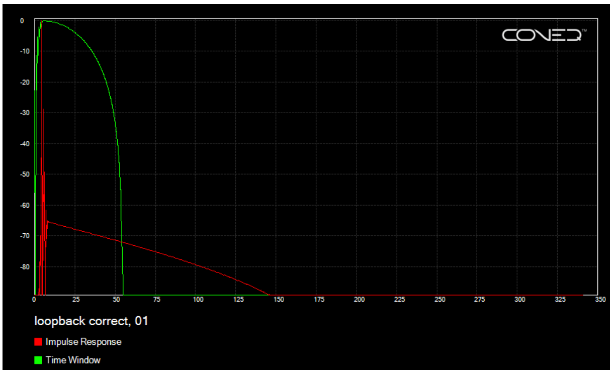
Figure 3: Grafico di una risposta di impulso loop-back corretta.
